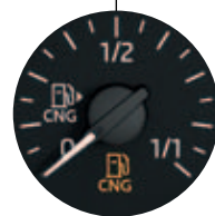
Kraftstoffanzeige für CNG
